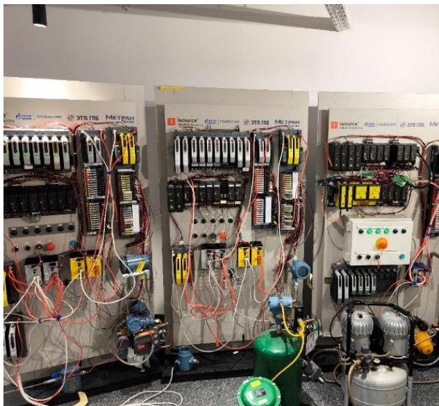
Рис. 3. Стенды для исследования протоколов связи и ППО АСУ ТП
